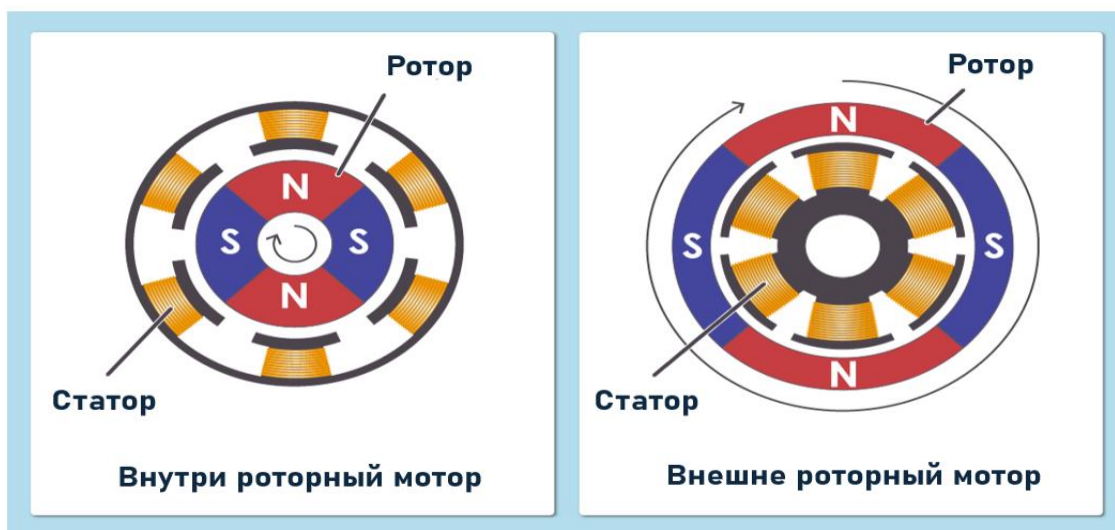
Рисунок 2.6 – Схема устройства BLDC мотора
