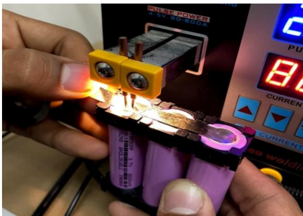
Рисунок 2.2 – Контактная сварка литий-ионных банок
